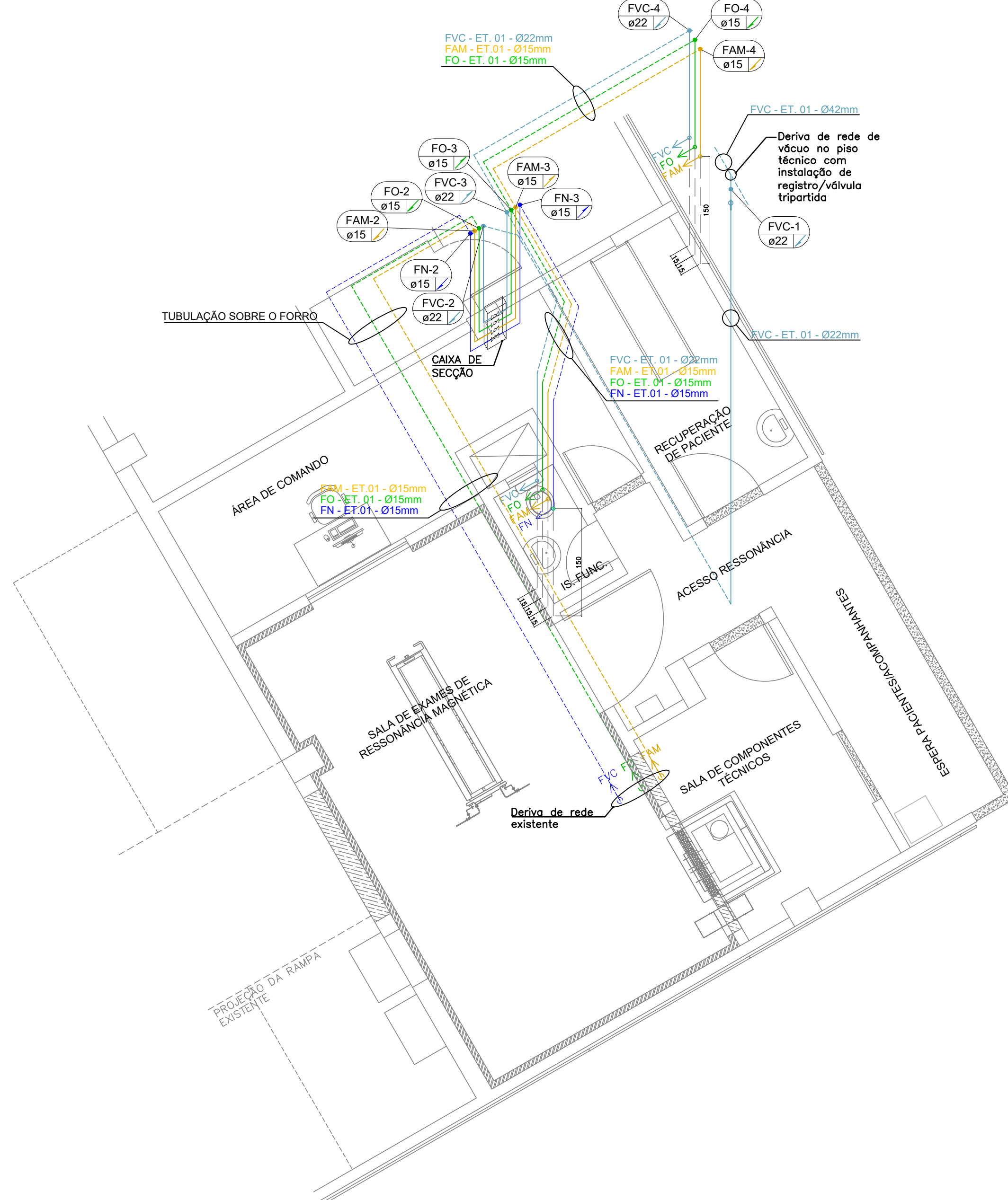
ISOMÉTRICO - REDE DE GASES MEDICINAIS - RESSONÂNCIA MAGNÉTICA ESCALA 1:50
