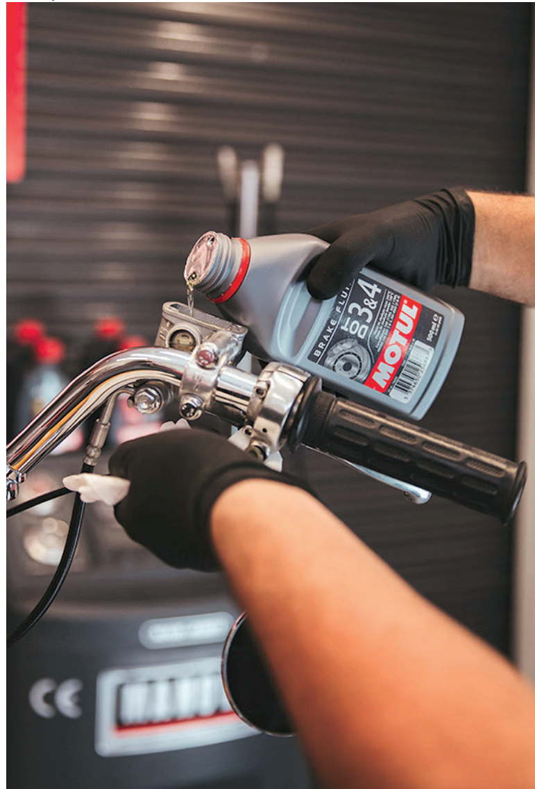
É comum que o nível do fluido de freio diminua com o desgaste das pastilhas e discos
